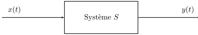
FIG. 3 – Représentation schématique d'un système transformant un signal d'entrée x(t) en un signal de sortie y(t) .
